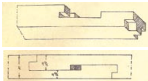
7 iliustracija. Rąstų sudūrimas „prancūziška spyna“, naudotas ten, kur reikia stipriau sudurti: tarpai virš langų ir durų, viršutinis vainikas (1936 m. šaltinis)
